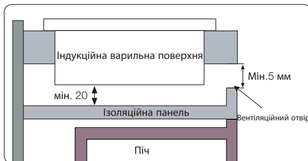
Встановлення варильної поверхні_63
