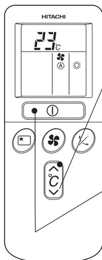
**2** Задайте требуемую температуру в помещении с помощью кнопки “ТЕМПЕРАТУРА” (текущее значение отображается на дисплее).
