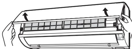
**2** С помощью пылесоса уберите всю пыль из фильтра. Если пыли слишком много, вымойте фильтр моющим средством и тщательно промойте его. Затем оставьте его сохнуть в тени.
