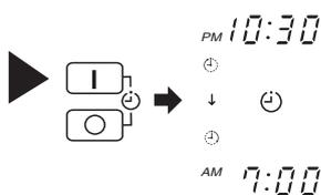
Пример: Для обогрева кондиционер выключится в 22:30 и затем включится раньше, чтобы к 7:00 заданная температура была почти достигнута; для охлаждения и осушки он просто включится в 7:00. Настройка времени включения и выключения теперь завершена.
