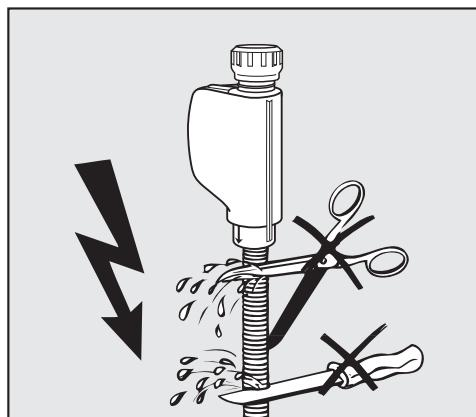
**⚠ Не допускается укорачивание или повреждение шланга подачи воды, так как в нем имеются детали, находящиеся под напряжением (см. рис.).**
