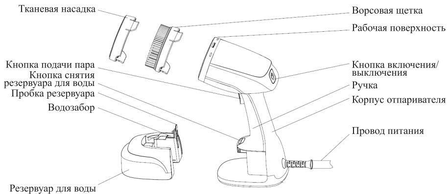
Резервуар для воды у отпаривателя съемный. Вода из резервуара подается в бойлер помпой (водяным насосом), где испаряется, пар выходит через паровые сопла на рабочей поверхности. Использование помпы позволяет точно дозировать количество подаваемой в бойлер воды и получать устойчивую подачу пара. Кнопкой «включения/выключения» (далее по тексту кнопка «вкл/выкл») выберите режим слабой или сильной подачи пара. Световой индикатор показывает, в каком режиме в данный момент работает отпариватель.
