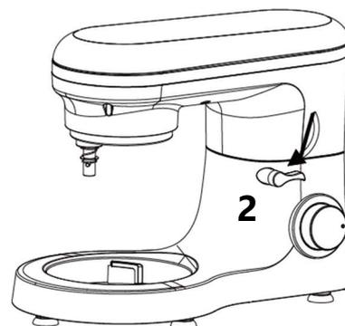
2. Присоедините крышку миксера к моторному отсеку и поверните ее, чтобы она стала на место.
