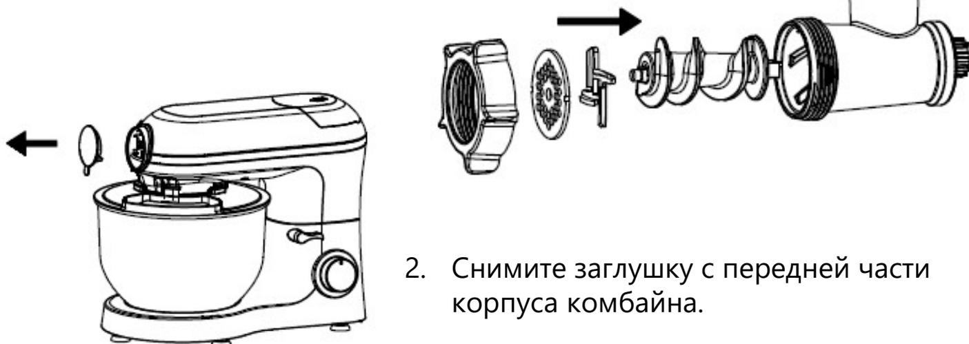
2. Снимите заглушку с передней части корпуса комбайна.
