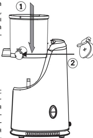
ковыжималки необходимо снять силиконовую накладку, хорошо промыть её и чашу, а затем снова закрепить на днище и перекрыть отверстие для выхода мякоти. Не забывайте закреплять накладку перед каждым включением соковыжималки! Это является одним из обязательных условий её безопасного и эффективного использования.
