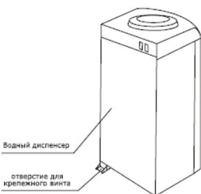
**Рис.2 Фиксация аппарата**
