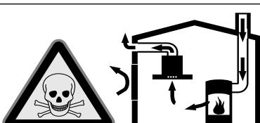
Источники пламени с подводом воздуха из помещения (например, работающие на газе, жидкотопливном, дровах или угле нагреватели, проточные водонагреватели, бойлеры) получают воздух для сжигания топлива из помещения, где они установлены, а отработавшие газы отходят через вытяжную систему (например, вытяжную трубу) из помещения на улицу.
