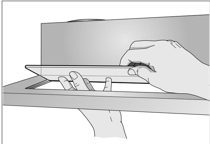
**Установка металлического жироулавливающего фильтра**
