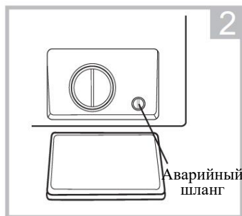
Поверните на 90° и вытяните аварийный сливной шланг, а затем снимите крышку шланга
