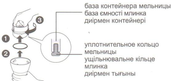
Поворачивайте базу контейнера мельницы в направлении по часовой стрелке до тех пор, пока не услышите звук “щелчка”.
