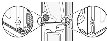
**3** Совместите отверстия в комплекте LG для вертикальной установки и отверстия в задней стенке.
