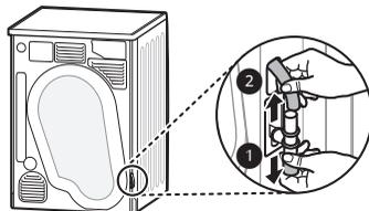
**2** Установите крышку защиты от обратного потока **1** на головку соединительного колена или тройника, а затем подключите дополнительный сливной шланг **3** к противоположной стороне соединительного колена или тройника.
