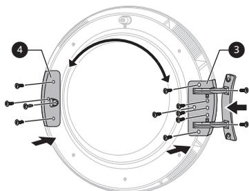
**7** Установите дверцу с извлеченными на шаге 1 винтами, а затем убедитесь, что дверца закрывается надлежащим образом.
