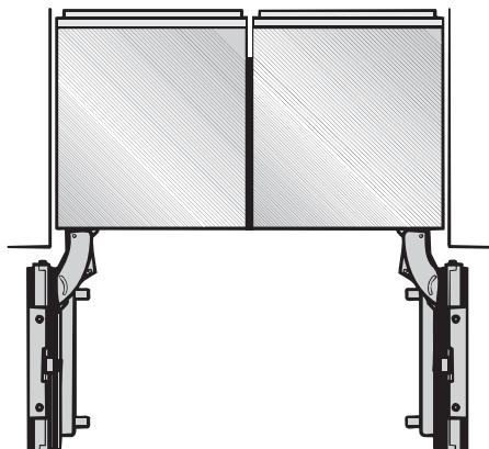
Если между приборами, расположенными рядом, нет промежуточной стенки, то приборы могут быть прикреплены друг к другу с помощью монтажного комплекта Side-by-side.
