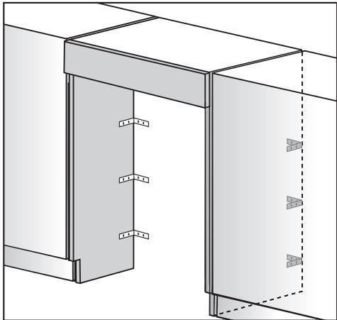
■ привинтите шкаф в нескольких местах к лежащей за ним стене с помощью подходящих крепежных уголков.
