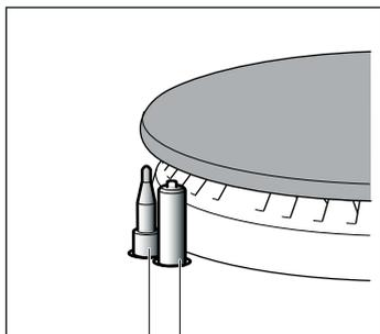
термопара | свеча
