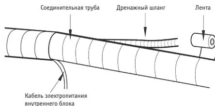
2. При обвязке оставьте некоторую длину дренажного шланга и кабеля электропитания для монтажа. Выполните обвязку до определенного места, отделите кабель электропитания внутреннего блока, затем отделите дренажный шланг.
