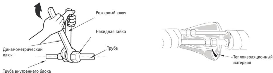
4. Оберните трубу внутреннего блока и патрубок соединительной трубы теплоизоляционным материалом, затем закрепите материал лентой.
