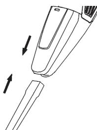
Если вы хотите использовать ручной модуль, то вставьте узкую насадку в отверстие пылесборника как показано на рисунке. При использовании ручного модуля отсоедините ручку.
