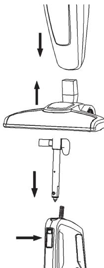
2. Вставьте до щелчка удлинительную ручку в отверстие на моторном блоке как показано на рисунке. Для отсоединения ручки нажмите фиксатор рядом с отверстием ручки.
